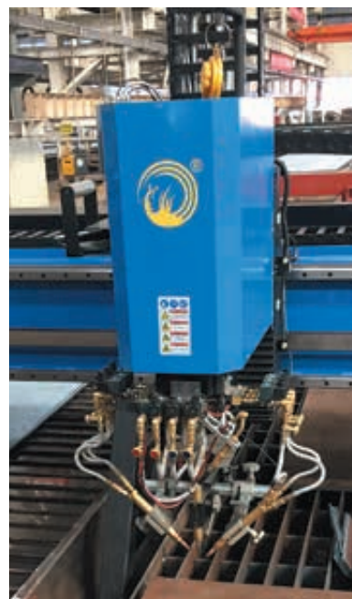
Трехрезаковый блок «3D bevel», вращение 420°
