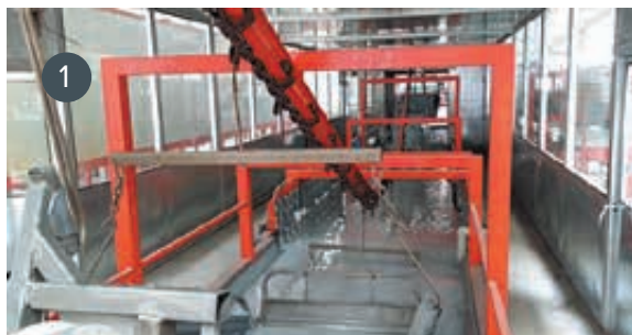
1 Система подготовки поверхности погружного типа
