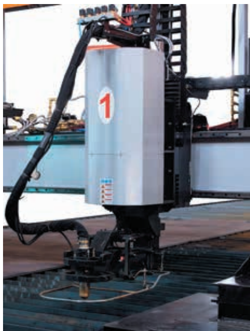
Модуль плазменной резки «3D bevel», вращение 360°
