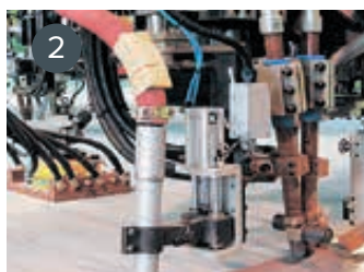
2 Оборудование для сварки встык, сварка с внешней стороны полотна
