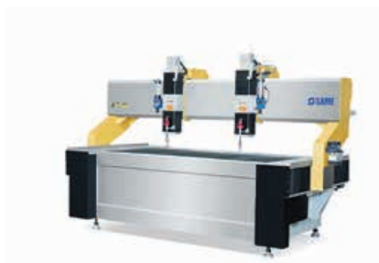
Система гидроабразивной резки с двумя режущими головами
