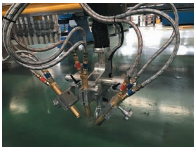
Трехрезаковый блок «1D bevel»
