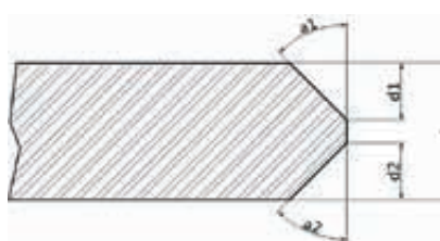
V/X фаска a_1 = 0^\circ - 85^\circ ; a_2 = 0^\circ - 60^\circ
