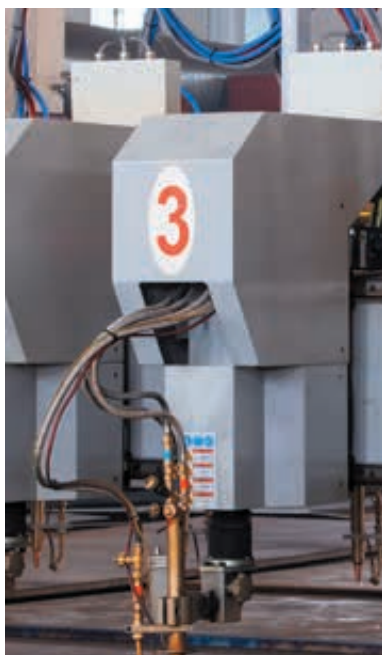
Газовая горелка для вертикального реза (с датчиком контроля высоты и устройством автоподжига)
