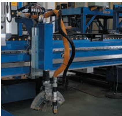
Модуль плазменной резки «1D bevel» (с ручной регулировкой угла оны плазмоторна)
