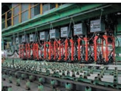
Автоматический модуль сварки элементов секций на 40 горелок
