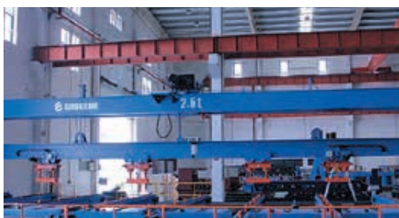
Перегрузатель с магнитной траверсой
